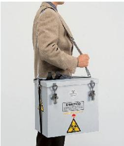
Valigetta di sicurezza per il trasporto di campioni biologici - in alluminio anodizzato - a tenuta stagna - 4 ganci di chiusura indipendenti a trazione regolabile - completo di cinghia per il trasporto a mano o a spalla - sterilizzabile in autoclave - dim. interne utili: 391x230x360 h mm - dim. est. 405x245x365 h mm.
